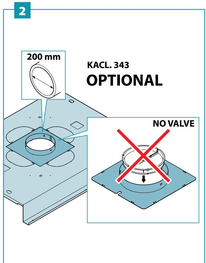
IT - Fissaggio tubo di aspirazione (3).
