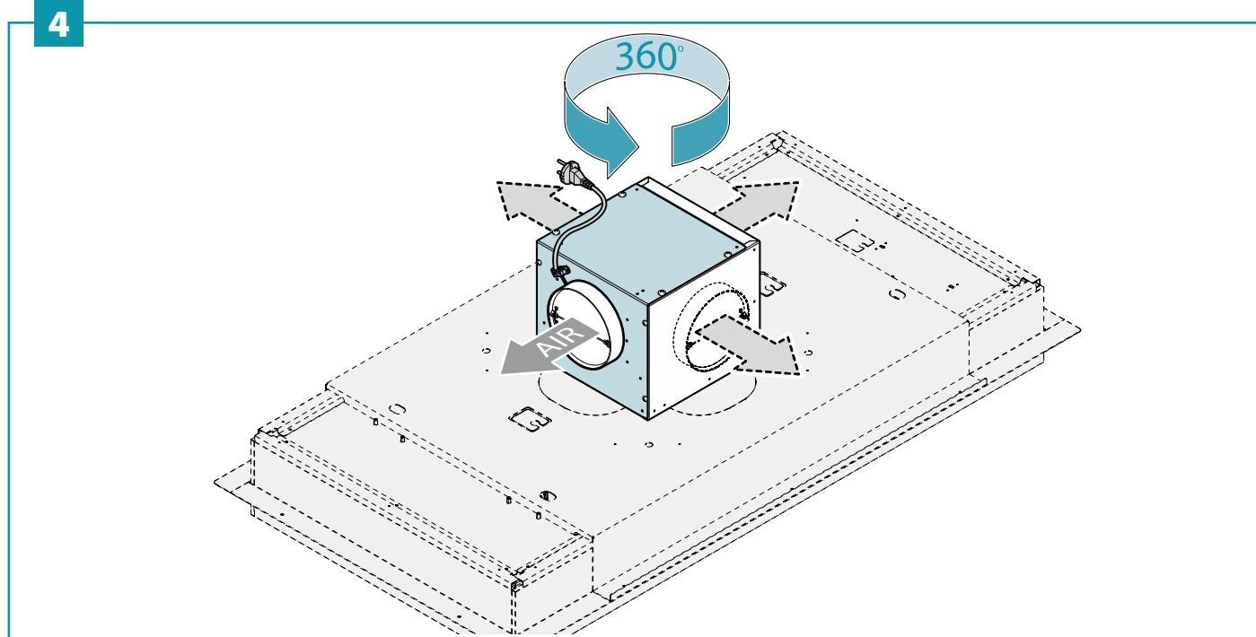
IT - Fissaggio motore su supporto motore (5).
